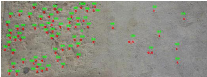
Fig. 11 Calcolo dell'erosione (volume dei fori) nel punto 2: a destra la parte della pavimentazione in calcare esposta agli agenti erosivi da circa 675 anni, a sinistra la parte esposta dall'epoca della costruzione.
