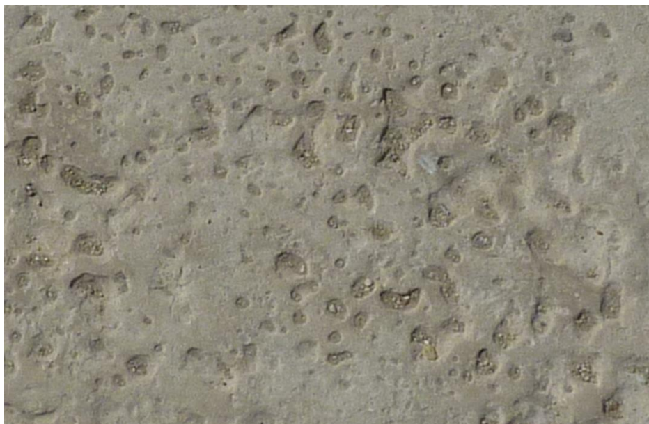
Fig. 3 erosione di tipo pitting su una roccia in calcare
